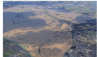
10月13日渡良瀬遊水地を上空から撮影。渡良瀬遊水地が利根川の水を貯留
