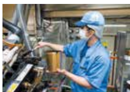
印刷の進捗を見てインクを補充します
