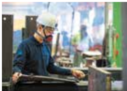
鉄骨構造部材が寸法通りにできているか検査
