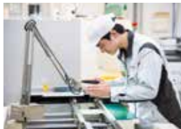
基板を目視で検査した後、検査機に通す
