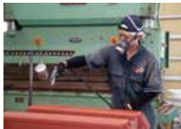
サビ止めを吹き付けてから部品を塗装します
