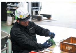
安全性を高めるネジボルトのバリを取り作業
